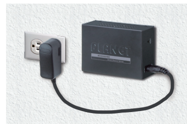
壁取り付け設置
