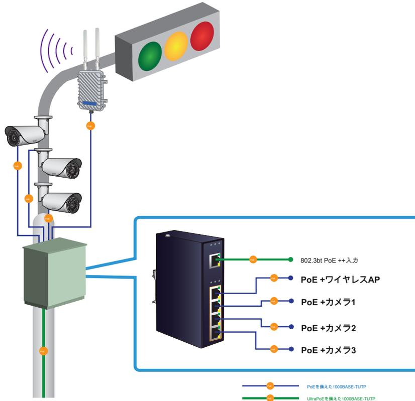
IPOE-E174産業用1ポート802.3btPoE ++から4ポート802.3af / atギガビットPoEエクステンダーは、インストール時間がほとんど必要なく、802.3btなどの電源デバイスからの標準RJ45ケーブルを使用した追加のセットアップやプログラミングも必要ありません。PoE ++インジェクターは802.3btPoE ++電力をIPOE-E174に供給し、IEEE 802.3af / atPoE規格に準拠する4つの受電装置の電力を変換します。つまりIPカメラやワイヤレスアクセスポイント用の追加の電源アダプターは必要ありません。
