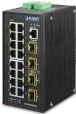
PLANET IGS-20040MTです 工業用20ポートのフルギガビットマネージドイーサネットスイッチ 特別に光ファイバを介してリモートネットワークへの要求の厳しい環境と順方向データ重工業における信頼性と高速データを送信するためにフルギガビットバックボーンを構築するために設計されました。それは提供しています 16ポート10/100 / 1000BASE-Tの銅 そして4余分100 / 1000BASE-X SFP光ファイバインターフェイス 冗長電源システムとIP30頑丈強い場合に送達しました。40Gbpsのためのサポートは、ファブリックが安全なトポロジでは、ビデオ、音声および重要な大量のデータを処理するために切り替えるほか、IGS-20040MTは、ユーザーフレンドリーが、高度を提供します IPv6の / IPv4の管理 インターフェイスと豊富なL2 / L4スイッチング機能。それは、産業ビジネスが拡大するが、そのネットワークインフラストラクチャをアップグレードするための最良の投資です。
